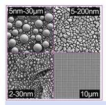
マルチ(4 種)標準サンプルは C 上の 5nm-30 $\mu$ m の Sn、粒径 5-200nm の Au、粒径 3-50nm、および 10 $\mu$ m Si グリッドの 4 種類の標準サンプルで構成されています。
