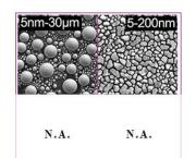
EM-Tec M2-2 マルチ(2種)標準サンプルは C 上の粒径 5nm-30 $\mu$ m の Sn と 粒径 5-200nm の Au の 2 種類の標準サンプルで構成されています。 テーブルトップ SEM および中~高倍率の標準 SEM での非点収差、解像 度およびグレーレベルのチェックに適しています。
