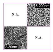
EM-Tec M1-2 は、C 上の粒径 5-200nm の Au および粒径 3-50nm の Au の 2 種類の標準サンプルで構成されています。
