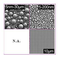
EM-Tec M5-3 マルチ(3種)標準サンプルは C 上の 5nm-30µm の Sn 粒径 5-200nm の Au、および 10µm Si グリッド の3種類の標準サンプルで構成されています。標準 SEM および テーブルトップ SEM での非点収差、解像度およびグレーレベル の低倍率から高倍率のチェックに適しています。
