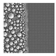
EM-Tec M6-2 マルチ(2種)標準サンプルは、Sn(5nm-30µm)が 10µm シリコングリッド上に載った標準サンプルです。 この組合せは、標準 SEM およびテーブルトップ SEM での非点収差、 解像度およびグレーレベルの低倍率から高倍率のチェックに適して います。
