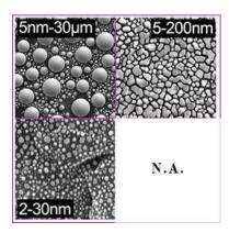
EM-Tec M2-3 マルチ(3 種)標準サンプルは C 上の 5nm-30 $\mu$ m の Sn、 粒径 5-200nm の Au および粒径 3-50nm の 3 種類の標準サンプルで 構成されています。
